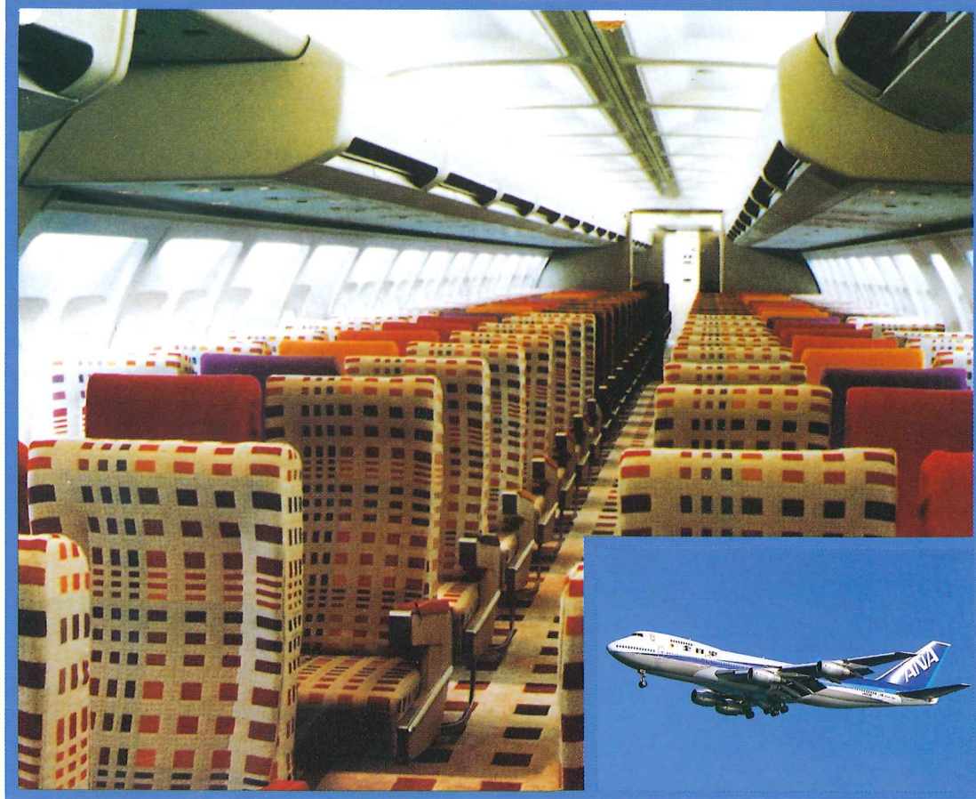
各種プラスチックにラミネートされた 航空機の壁・天井・物入れ(ボーイング社製)
